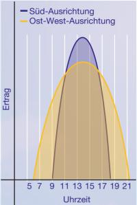
Bei einer Ost-West-Ausrichtung der Anlage ist der Energieertrag, bezogen auf die installierte Leistung, um ca. 15 % geringer als bei Süd-Ausrichtung.
